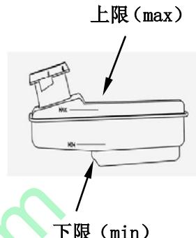
如果在不长的时间内制动液的液位明显下降，则表示制动系统存在漏油现象。如出现此情况，应立即到东风柳汽认可的服务站检修汽车。
