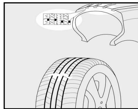
必须保持轮胎的良好状况，轮胎表面花纹应有足够深度。风行认可的轮胎都有标记 A 来测量轮胎磨损程度，这个标记就是轮胎行驶带里面的凸起点。
