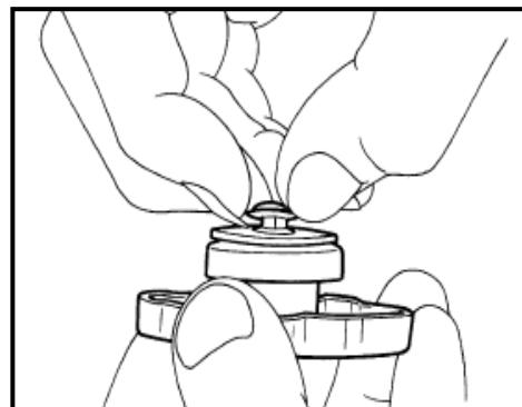
② 检查散热器盖释放压力。
